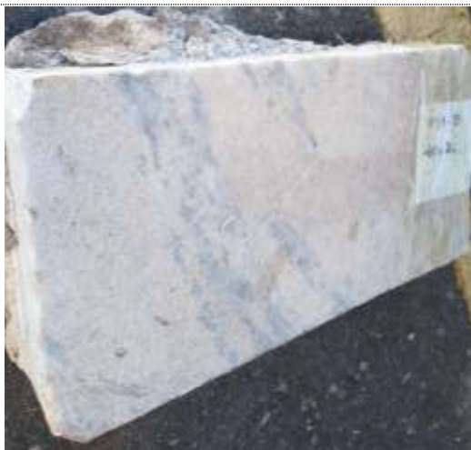
Fotografia 36: Amostra do revestimento de mármore retirado para desenvolvimento do estudo de recuperação das pedras;
